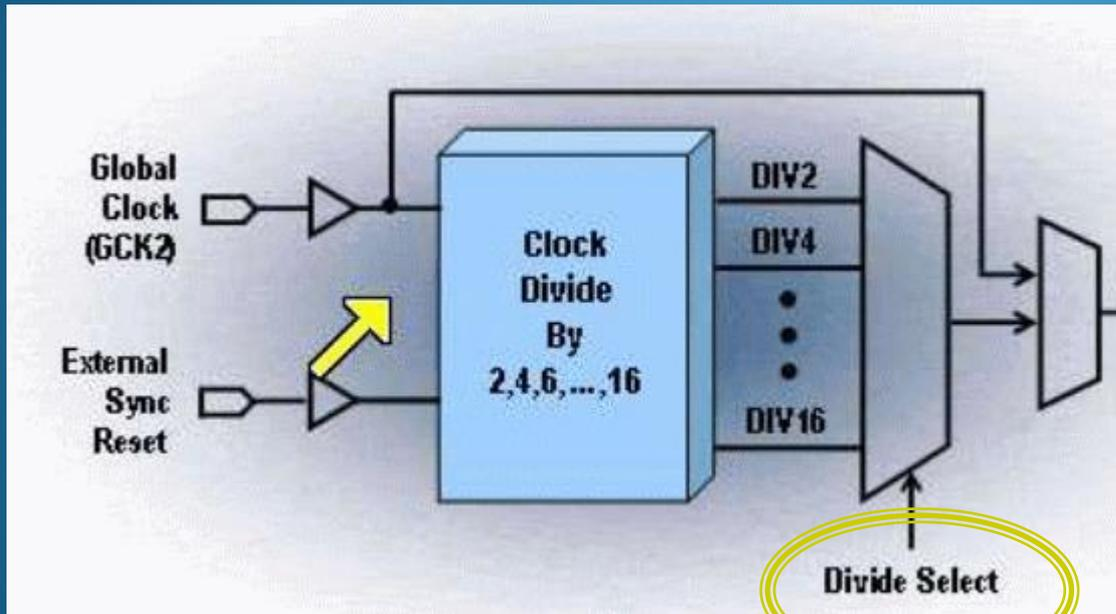
Esquemático obtenido de uno de los circuitos internos que emplean varios productos de lógica programable de la empresa Xilinx para posibilitar la división interna de la señal de reloj externa (Global clock).
