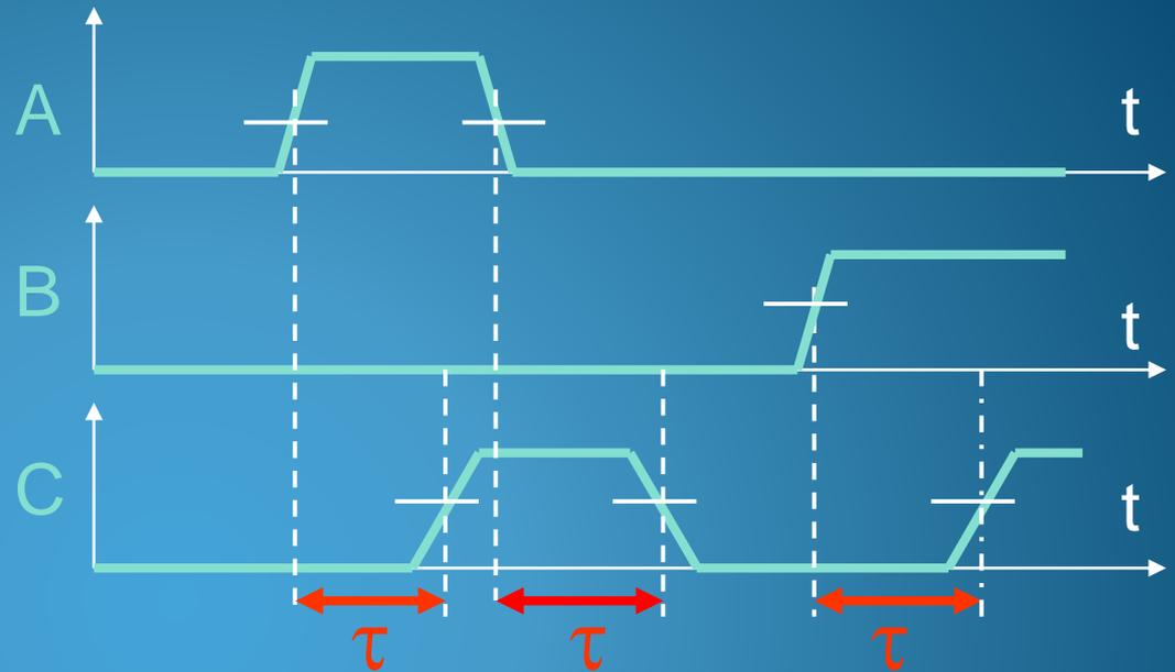
Las formas de onda de tensión en compuertas pueden aproximarse mejor si se considera el tiempo de subida (rise time) y el de bajada (fall time) con un valor diferente de cero.
